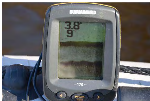
13 pav. Dugno reljefo vaizdas echoloto ekrane.
