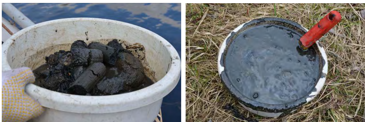
15 pav. Paimtas ir homogenizuotas dumblo bandinys.
