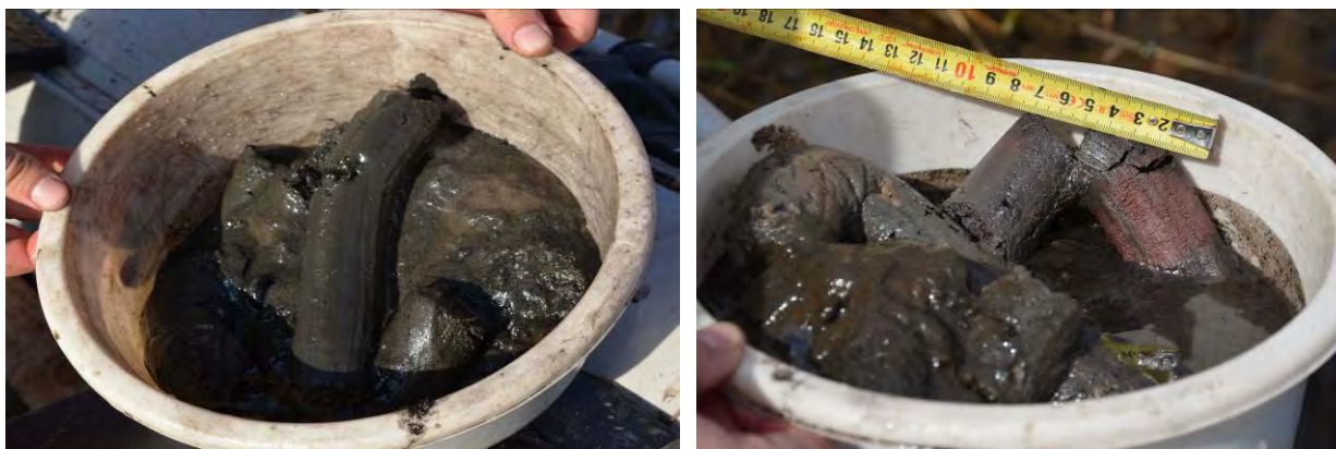
16 pav. Dumblo bandiniai su smėlio (kairėje) ir gamybinėmis (dešinėje) priemaišomis.
