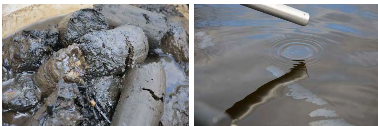
17 pav. Dumblo bandinys užterštas naftos produktais ir jų pėdsakas vandens paviršiuje.
