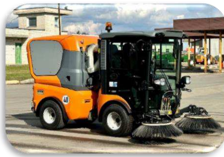
1 pav. Šaligatvių valymo 0,9 m 3 bunkerio talpos automobilis KARCHER MC 130
