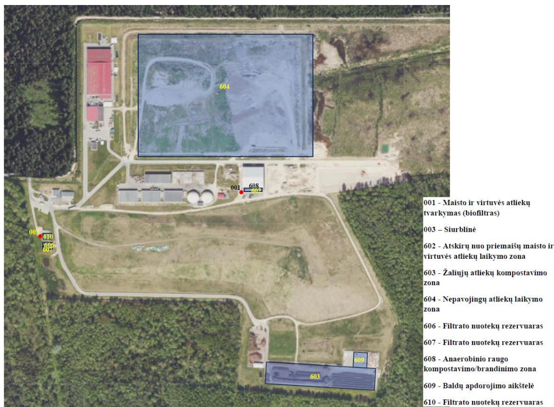
34 pav. Sąvartyno oro taršos šaltinių schema
